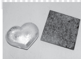
生型鑄造法で作った小皿（左）と 伝統の着色技法で発色したコースター（右）
